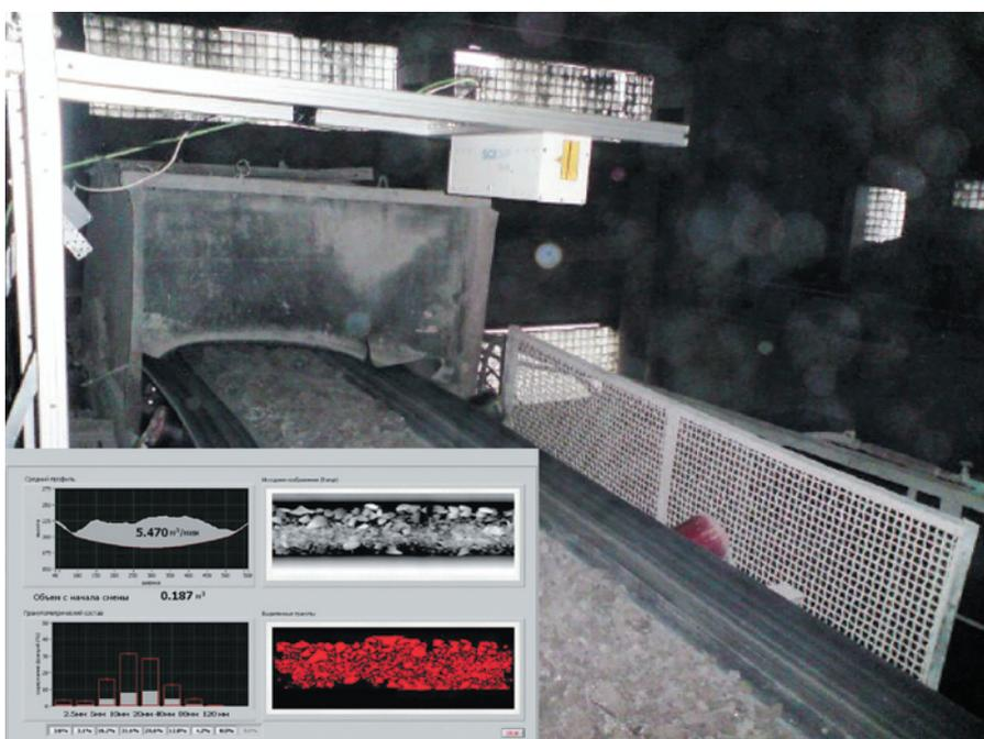
Непрерывное измерение и регистрация объема материала и гранулометрический анализ осуществляются на основании сканирования трехмерного профиля высоты слоя породы на ленте синхронно
