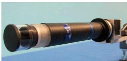
Инженерами нашей компании реализована установка, предназначенная для визуального контроля качества внутренней поверхности полых деталей цилиндрической формы.
