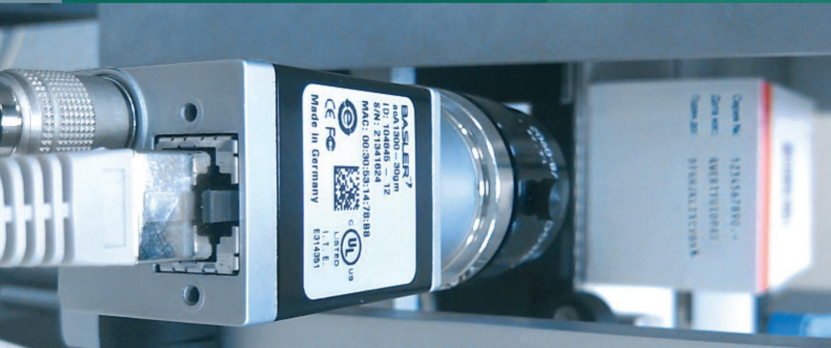
Система машинного зрения АСККМ «Ангара» предназначена для выявления и отбраковки дефектов маркировки этикеток, акцизных марок, коробок, флаконов, ампул, бутылок и пр., имеющих визуальные проявления в области постоянной или переменной печати.
