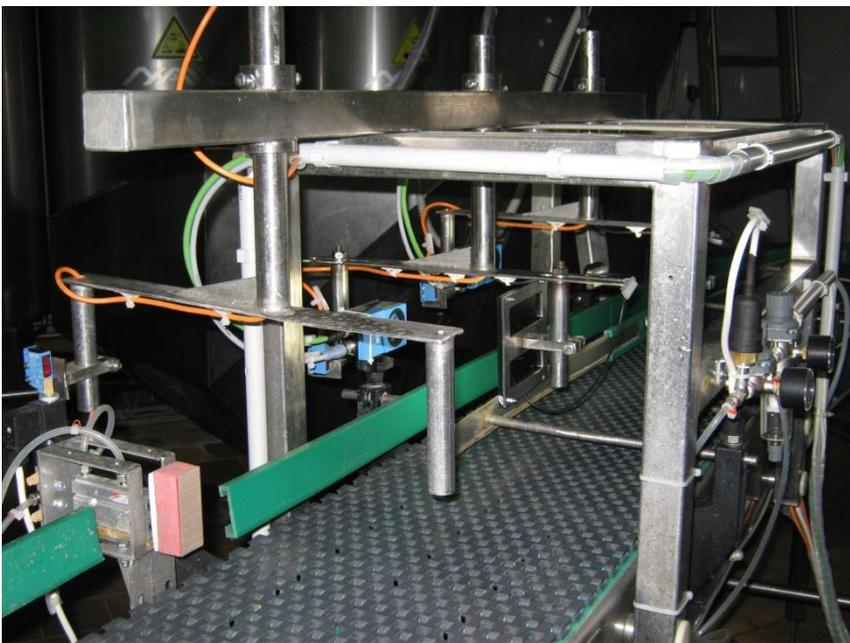
Система автоматизирует две инспекции, производимые поочередно в процессе движения бутылки по производственному конвейеру. Первая инспекция проверяет наличие крышки и целостность контрольного кольца. Проверка производится видеодатчиком SICK по изображению контура бутылки на подсвеченном фоне. Вторая инспекция проверяет, находится ли
