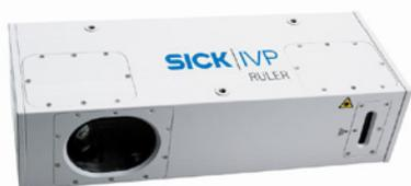
Основой комплекса стала интеллектуальная трехмерная камера SICK-IVP Ruler 600E. Трехмерное изображение строится на принципе лазерной триангуляции и последовательного сканирования перемещающегося объекта, в нашем случае вращении колеса. Скорость сканирования может составлять до тысяч сканов в секунду, что обеспечивает точное и быстрое получение трехмерной поверхности объекта.
