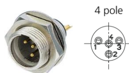
Рисунок 2 Розетка miniXLR и нумерация выводов (вид на контакты спереди)
