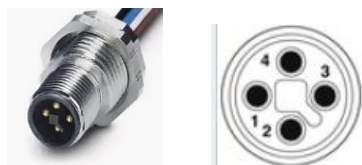
Рисунок 5 Вилка M12 на корпус и нумерация выводов (вид на контакты спереди)
