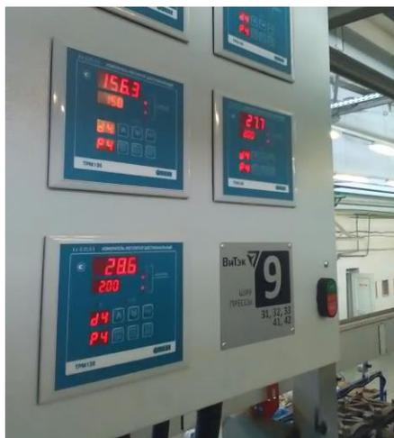
Система предназначена для задания и контроля требуемой температуры плит нагрева установленных на гидравлических прессах, а также для мониторинга давления прессования на гидравлических прессах.
