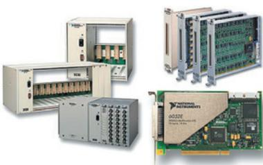
Аппаратная часть комплекса построена на базе оборудования National Instruments: корзина SCXI-1001, тензоусилитель SCXI-1520, модуль ввода частотных сигналов SCXI-1126, изолированные усилители общего назначения — 1125, SCXI-1121, модуль ввода дискретных сигналов SCXI-1162HV, модуль вывода дискретных сигналов SCXI-1161, измерительная многофункциональная плата PCI-6052E.
