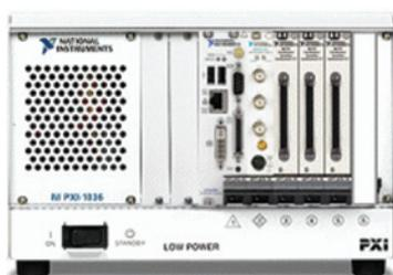
Измерительный блок представляет собой корзину PXI-1036 с контроллером PXI-8102RT, тремя платами АЦП PXI-6143 и осциллографом PXI-5122. Согласующее устройство содержит: 12 датчиков напряжения LV-25-P производства компании LEM и 12 модулей SCM5B производства компании Dataforth.
