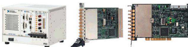
Аппаратная часть реализуется на базе оборудования National Instruments PXI4472/4474, PCI NI 4461/4462, NI 6024E, NI PCI 6251, NI cRIO, NI SCC. При разработке прикладных программ использовалось программное обеспечение National Instruments LabVIEW.
